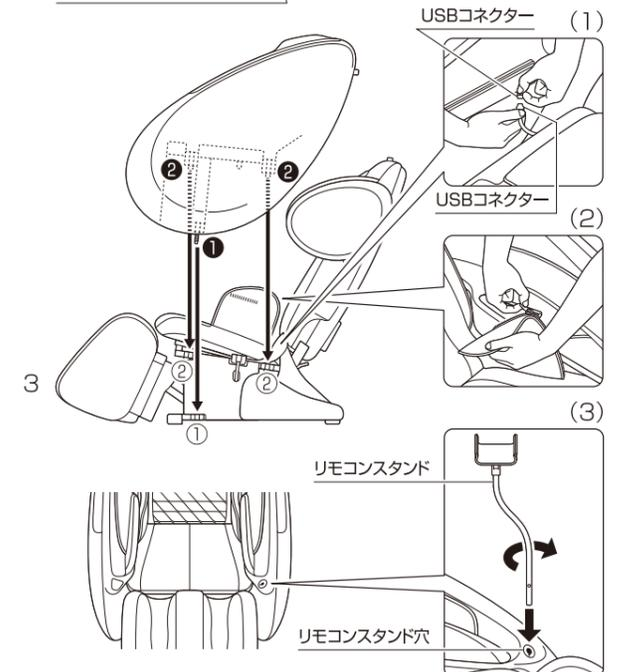
4. ヘッドレストを背もたれのヘッドレスト固定ベルトに通してセットしてください。
