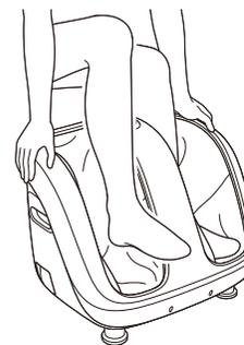
使用中に停電になり、もみボードが開いた状態で停止した場合は、本体ケースを両手で押さえて片足ずつ抜き出してください。
